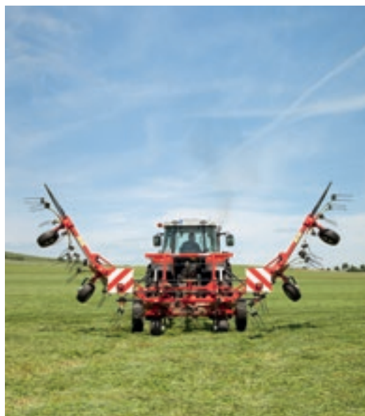
Synchroon inklappen van de rotoren
