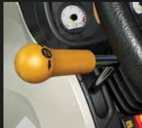
Der Wechsel zwischen Vor- und Rückwärtsfahrt an Vorgewenden, auf dem Hof oder beim Ankoppeln von Anbaugeräten gestaltet sich dank des links neben dem Armaturenbrett angebrachten, mechanisch synchronisierten Wendeschalthebels denkbar einfach.
