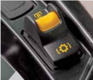
Das Einkuppeln der Zapfwelle erfolgt wie gehabt auf elektrohydraulische Weise mithilfe des vertrauten Sicherheitsschalters mit 3 Positionen (Ein, Aus und Sperren/Bremsen).
