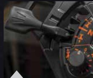
Der optionale, linkshändig bedienbare, kombinierte Servofahrtrichtungswechselhebel erlaubt in Kombination mit dem hochmodernen Getriebe das kinderleichte Wechseln der Fahrtrichtung zwischen den drei Optionen Vorwärtsfahrt, Rückwärtsfahrt und Leerlauf. Zur Steigerung des Fahrkomforts lässt sich das Ansprechverhalten der Wendeschaltung mithilfe des ComfortControl - Drehreglers anpassen – die ultimative Kombination beim Frontladereinsatz.
