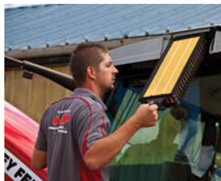
Het cabineluchtfilter kan eenvoudig worden verwijderd om te reinigen.
