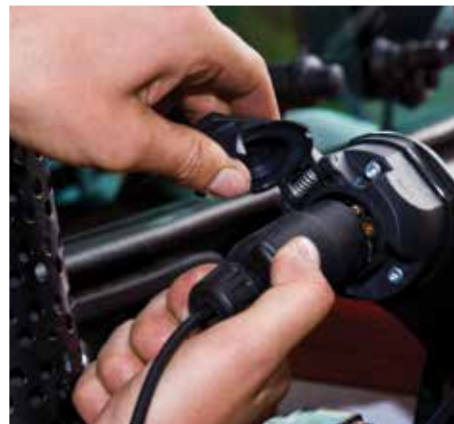
03. Elektrische aansluitingen afkoppelen.
