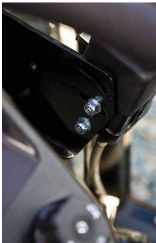
02. De positie van de hendel kan worden aangepast voor comfortabele bediening.
