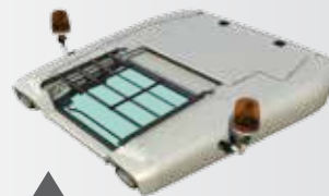
Visio dak met bescherming tegen vallende voorwerpen
