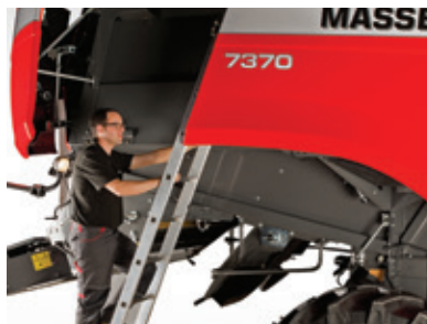
Veilige toegang tot het motordek en de graanbunker, dankzij verwijderbare ladder
