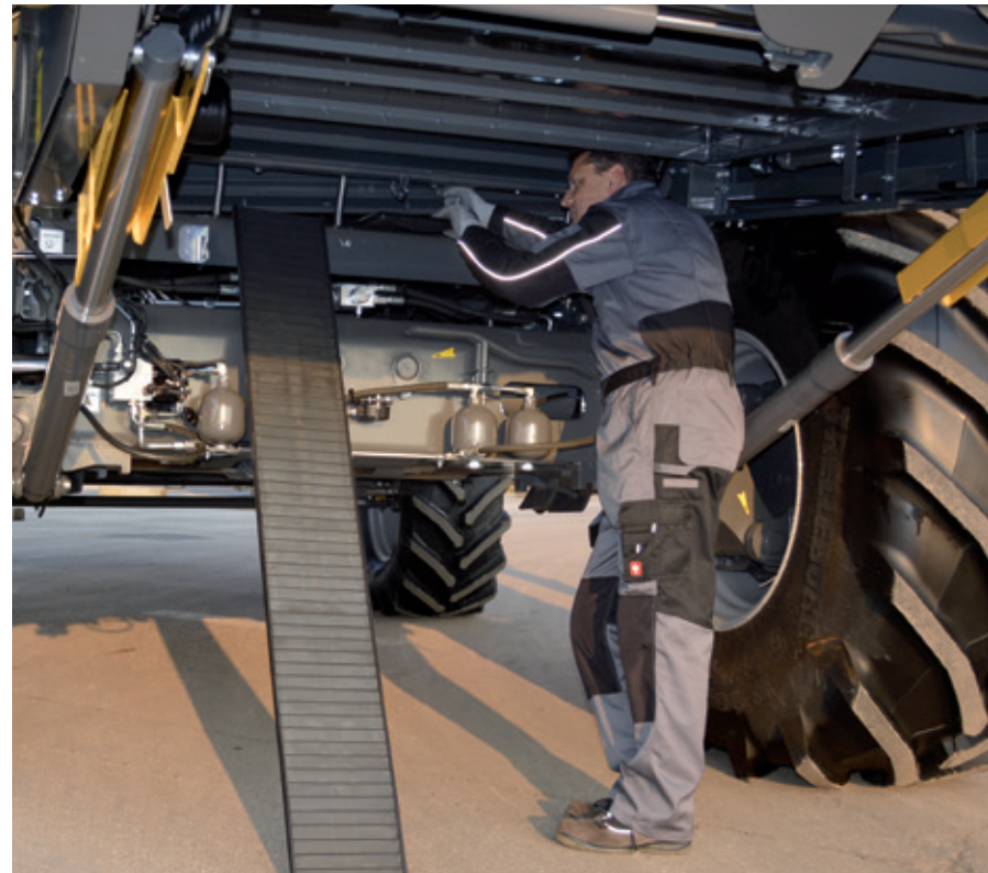
Eenvoudige toegang tot delen van de nieuwe verwijderbare voorbereidingsbodem voor snellere en gemakkelijkere reiniging en onderhoud
