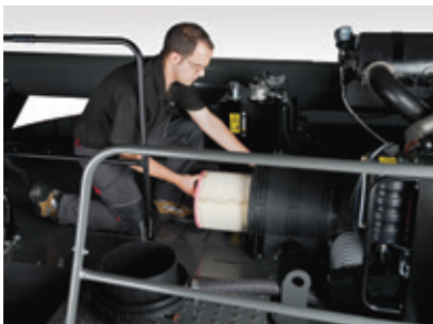
Controle en reiniging van het luchtfilter
