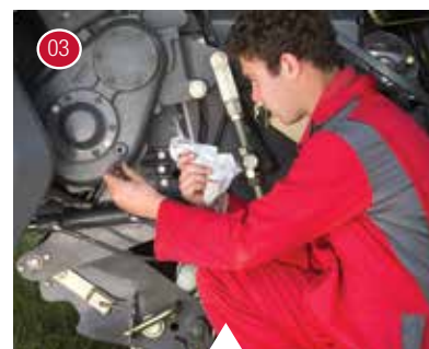
Oliepeil van snijinrichting tandwielkast controleren.
