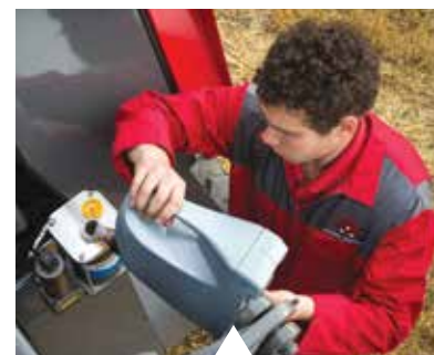
Automatische kettingsmering bijvullen.
