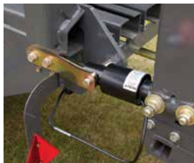
Zeer nauwkeurige weegstaven voor het geïntegreerde baalweegsysteem.
