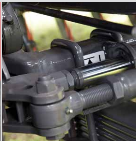
Hydraulische vergrendeling van achteras.
