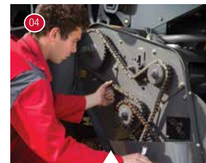
Spanning van pick-up kettingen controleren.
