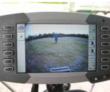
Op de grootpakpers is de bedrading voor een videocamera al aanwezig. De C1000 balenpers monitor is standaard volledig geschikt voor kleurenvideo.
