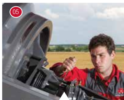
Slipkoppeling van vlieg wiel afstellen.
