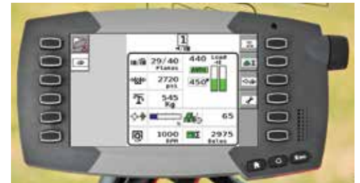
Automatische dichtheidsregeling via de C1000 balenpers monitor.
