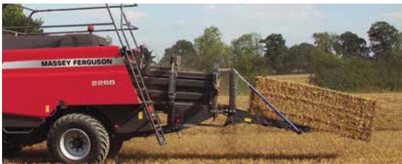
Het IBWS (Geïntegreerd Baal Weeg Systeem) weegt de baal als die de kamer verlaat en de rollenbaan opgaat.
