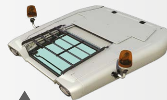
Visio-dak met bescherming tegen vallende voorwerpen
